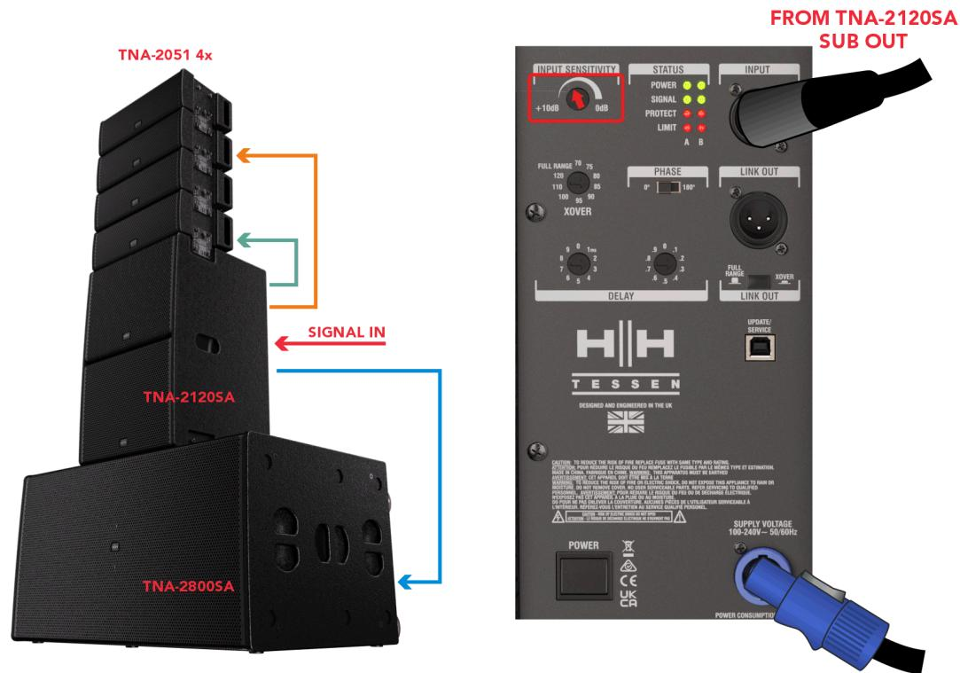
上記のように TNA-2120SA のラインレベルサブ出力から TNA-2800SA を接続し、フルレンジ TNA システムの一部として使用します。電源を入れ直す手順に従って、TNA-2800SA の入力感度を徐々に適切なレベルまで上げてください。
